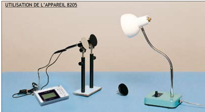
Soumettre deux disques identiques en aluminium, un coloré en noir et l'autre brillant, à la lumière d'une lampe de 100W et placer sur chaque disque une sonde de température, on observe que le coefficient d'absorption du disque noir (ligne verte) est plus grand que celui du disque brillant (ligne rouge).
