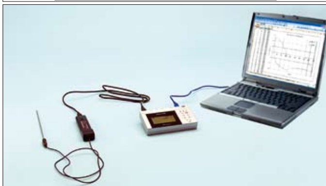
IMAGE 1: CONNEXION D'UN CAPTEUR PAR LE BIAIS D'UNE INTERFACE
